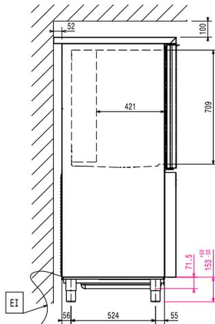
EI = Conexión eléctrica (energía)
